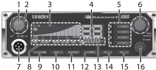
1. Rueda del **control del volumen (Volume)** con **Power On/Off** (encendido/apagado de la alimentación). Gire la rueda en el sentido de las manillas del reloj hasta que haga clic para encender o en contra del sentido de las manillas del reloj para apagar la corriente.
