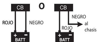
Conecte el cable rojo de alimentación CC del transceptor al borne positivo (+) de la batería o a otro punto conveniente. Luego conecte el cable negro de alimentación al chasis del vehículo o al borne negativo (-) de la batería.
