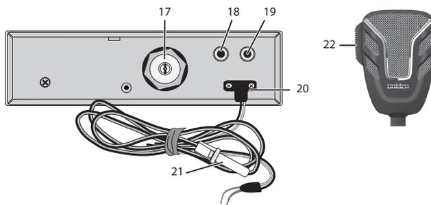
17. Enchufe para la antena: Conecta la antena a la unidad.
